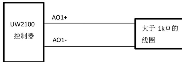
AO 输出 20mA 时，AO 两端同时输出 DC20V，线圈吸合。
