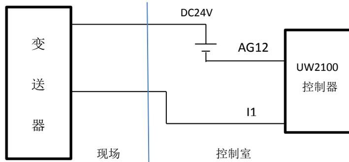
② 三线制变送器接线示意图
